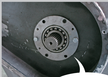
Particolare del supporto laterale con viti di estrazione del cuscinetto
