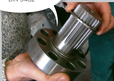
Particolare mozzo con scanalatura DIN 5482
